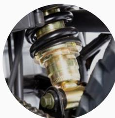
Monoamortiguador hidráulico regulable.
